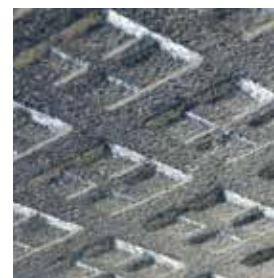
Multisquare-Profil an der Unterseite
